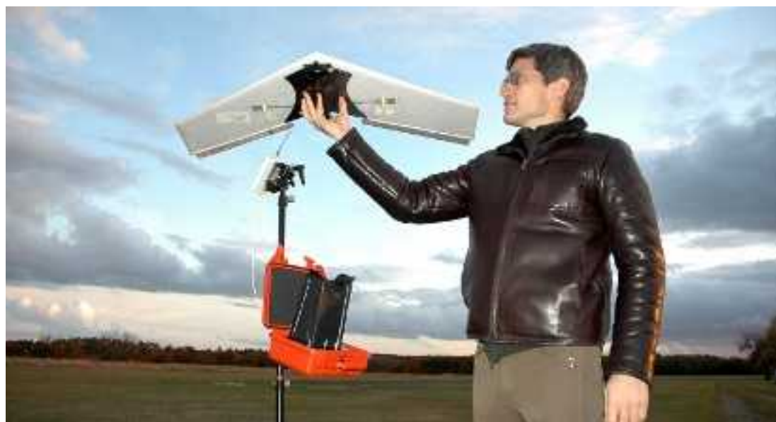
Un mètre d'envergure, un poids de 750 grammes : l'engin peut être lancé à bout de bras par une personne seule et son pilotage s'apprend en deux heures de formation.
